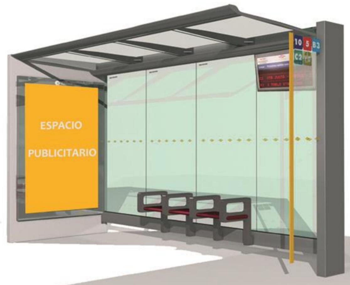
Fig. 151.- Propuesta 3D de diseño de parada de autobús.
