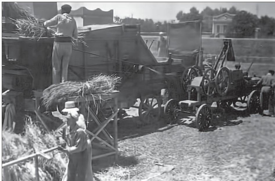
Trilladora de la Cooperativa Catòlica Agrària. Baix a l'esquerra, s'observa com descarreguen la civera i, a la dreta, es veu l'empacadora automàtica. Foto cedida per la Cooperativa Catòlica Agrària
